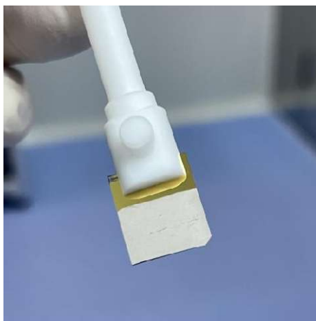
图 4-1 小片样品进行电镀测试
