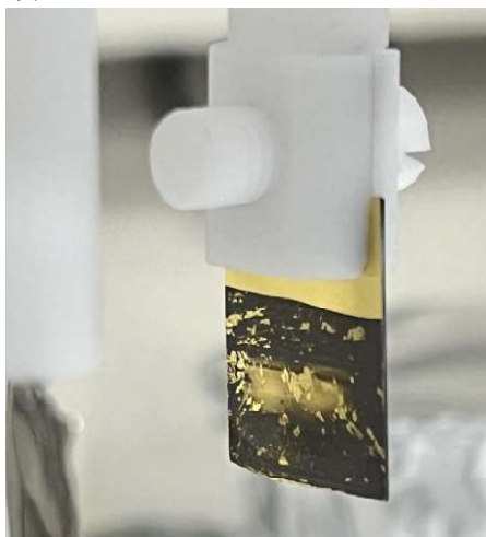
图 4-5 电流密度为 2 \text{ mA/cm}^2 时的电镀效果
